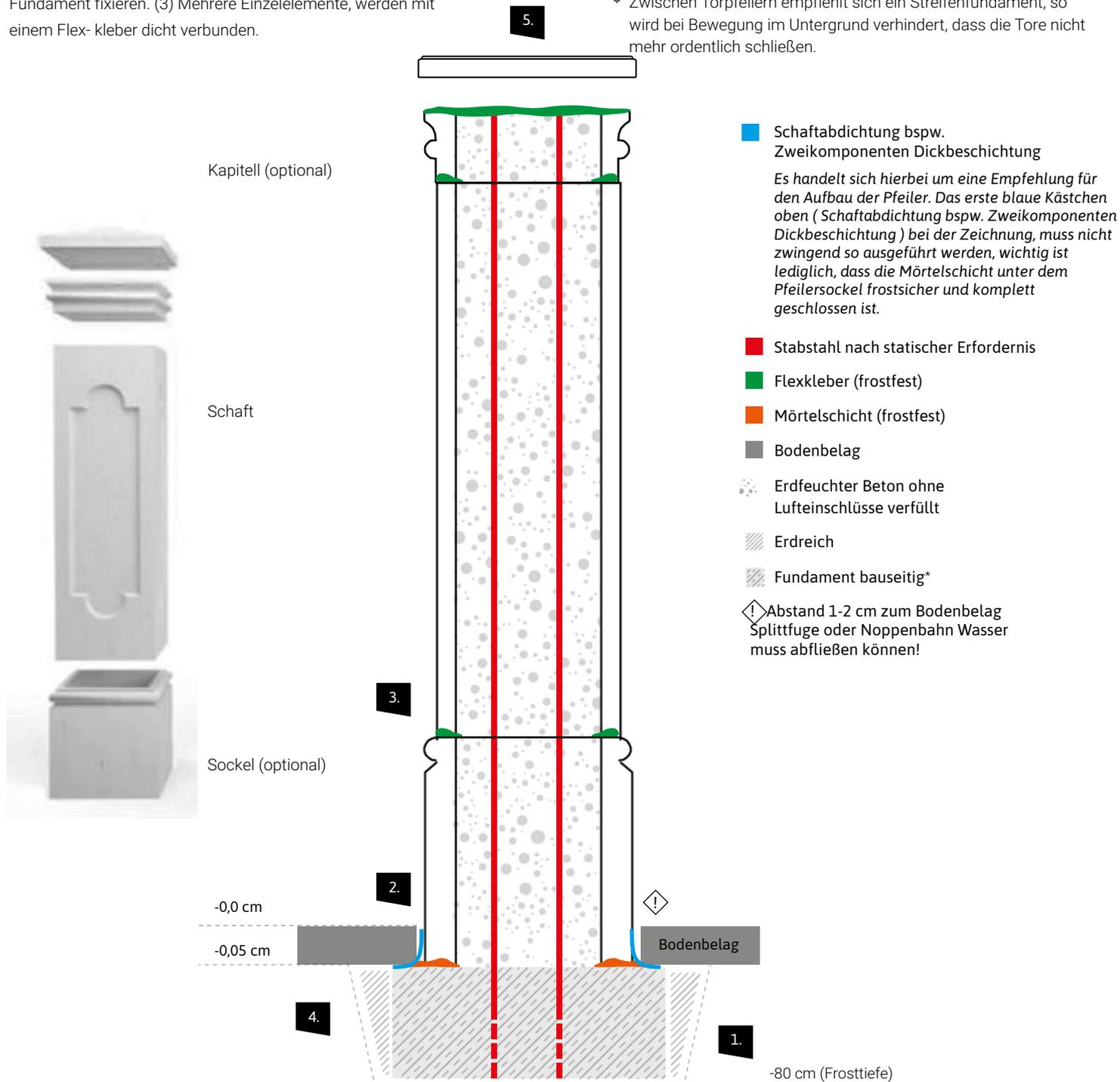
Die Fertigung erfolgt nach DIN 18500. Die Betongüte entspricht, wenn nicht anders angegeben, C25/30; XC4; XF1.
